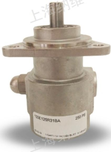
美国PROCON加仑水泵，125加仑高压水泵。上海纳维环保设备有限公司提供PROCON叶片泵，大量现货，上海库存，一台起售。PROCON加仑水泵为黄铜叶片泵，流量125加仑/小时（375升/小时），压力250PSI（约17公斤），扬程140-170米，可用于水处理、冷却系统、激光系统、焊切割设备、咖啡机、小家电、自动售卖机、啤酒输送系统等，具有压头高、震动小、可自吸、自润滑、耐磨、不阻塞、卫生、低噪音等。PROCON2系列水泵主要应用于意式咖啡机、焊接设备，主体材料为黄铜，不带过滤器，可选择带或不带安全阀，流量范围15加仑至140加仑，压力250PSI自吸，卡扣/法兰连接。
